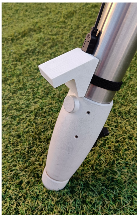
Figura 4. Dispositivo alojado en carcasa impresa en 3D.
